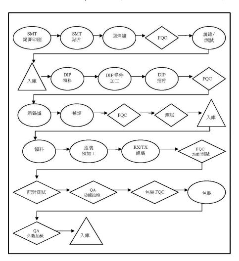
每一階段設有 FQC 及測試人員檢查站進行品質檢測,若出現 NG 情形即進入品保/維修/IPQC 程序做改善處理,於最後第三階段入庫前進行功能測試、配對測試。QA 人員負責功能抽檢及在包裝完成後另做外觀抽檢,若有 NG 情形則做返工處理,IPQC 並於每節課追蹤改善品質狀況。
